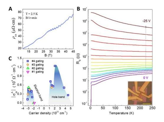
对于较厚的 CsV<sub>3</sub>Sb<sub>5</sub> 纳米片(>40 nm), 研究人员发现较小的门电压(<7V) 不会改变超导转变温度,即无序效应被极大地抑制。然而,低温霍尔电阻的斜率在门电压下被连续改变,表明在较厚的纳米片中施加较小的质子门电压即可实现载流子浓度的大范围调控。我们发现,体系中巨大的反常霍尔效应发生在布里渊区中 M 点附近的空穴带中(对应的空穴浓度 2x1022cm-3),并且首次在电子带中也观测到大的反常霍尔效应。结合理论分析与计算,我们发现体系中巨大的反常霍尔效应主要起源于平带中空穴的斜散射。
