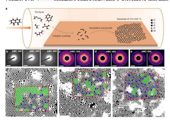
研究人员利用密度泛函理论计算和蒙特卡洛计算成功关联了二维非晶碳的原子结构和电学性质,揭示了 AMC 导电性差异的微观机理: AMC-300 与 AMC-400 导电性差异的主要来源是中程序的有无; AMC-400 和 AMC-500 的中程序差异不大,其导电性的差异则主要源于纳米晶区域的密度。为此,研究人员引入了一个新的结构序参量一跳跃岛密度;结合中程序,成功绘制了"微观结构-宏观导电性能"相图。这一发现也表明了非晶材料无序度的复杂性,难以直接用中程序完备描述其构效关系。该工作首次在一个非晶材料实例中实现了精准的构效关系,为二维材料、非晶材料物理及应用等领域提供了全新思路。
