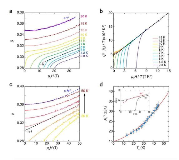
高温超导微观机理是凝聚态物理最具挑战的科学难题之一。当高温超导电性被外磁场破坏后,其正常态电阻率会展现出随温度线性变化(从高温延伸至接近绝对零度)的"奇异金属"行为。物理所金魁、陈其宏研究团队采用脉冲激光沉积法生长了FeSe薄膜,并利用离子液体调控技术进行电子掺杂,实现了FeSe的超导转变温度 Tc 从 8K 至 45K 的连续调控。然后利用脉冲强磁场设施的 50T 强磁场压制超导,首次获得了 FeSe 体系奇异金属态的实验证据:强磁场下正常态电阻率随温度线性依赖、低温下正常态电阻率随磁场线性依赖、以及磁电阻率随温度和磁场的 H/T 标度不变行为。通过离子液体精细调控获得了
