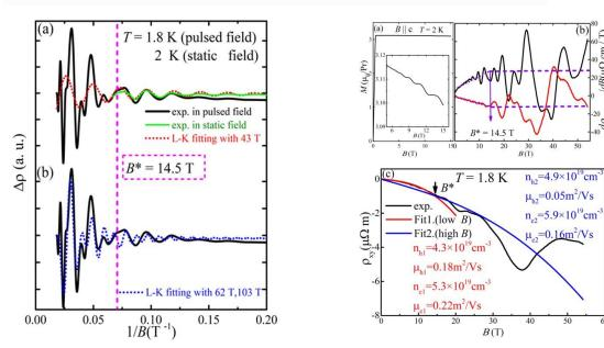
其次,综合第一性原理计算得到的费米面和角度依赖的 SdH 振荡的分析可知, Lifshitz 相变发生在布里渊区 Γ-X 方向且具有外尔特性的费米口袋上(如图4)。由于 PrAlSi 中 Pr-4f 电子能带远低于费米能级以及其低载流子浓度的特性,排除了塞曼项和近藤效应的作用。另外,Pr3+引起的晶体场效应也可能是该磁场诱导 Lifshitz 相变的原因,其物理机制需要更丰富的实验来验证。
